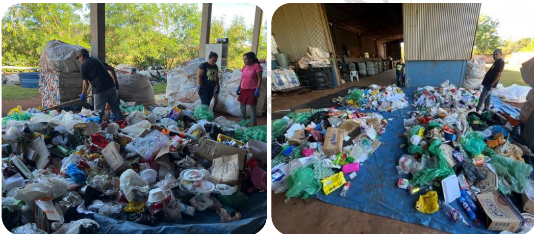
Figura 25: Homogeneização e quarteamento dos resíduos da coleta seletiva.
